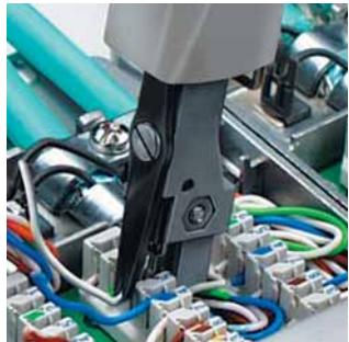
Vtláčení a ustřízení kabelu v jedné pracovní operaci
