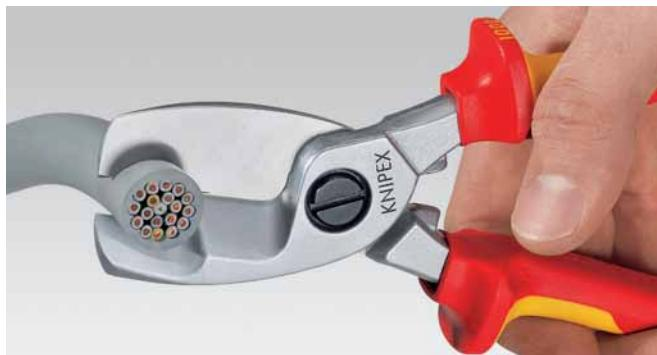
Přípravný řez: díky použití předního břitu pro řez izolačního opláštění zůstává u větších průřezů kabelů zachováno ergonomické rozvěření rukojetí.
