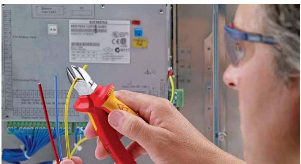
Štípací kleště KNIPEX podle normy
