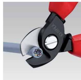
Přestřízení kabelu kleštěmi na kabely: lehký, čistý řez bez deformace kabelu
