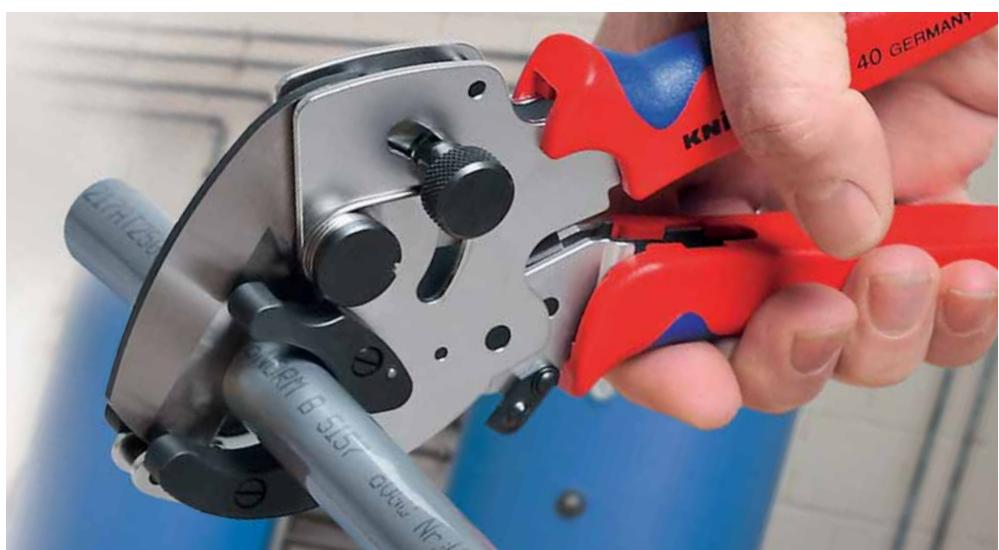
*V podlahových topeních se používají převážně silnostěnné plastové trubky. Se správnými nůžkami na trubky KNIPEX je můžete přesně uříznout a ušetřit přitom sílu.*
