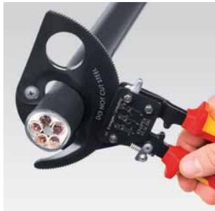
Princip rohatky se západkou a dvoustupňový pohon ozubeným věncem pro stříhání šetřící síly
