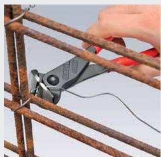
Tvar hlavy umožňuje optimální pohyb při upínání fíkového uzlu při armování.
