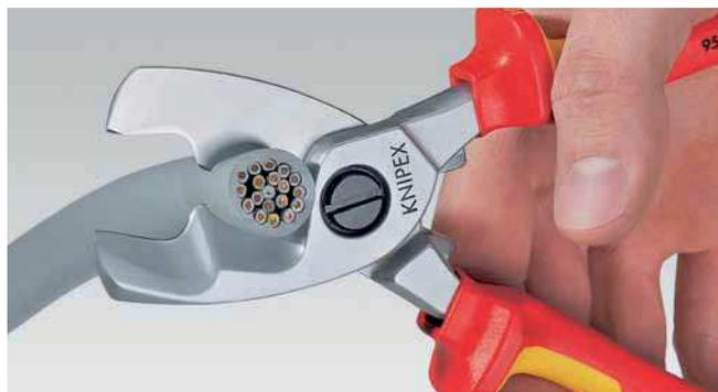
**Dokončovací řez:** po prostříhnutí pláště kabelu v předním profilu se vodiče oddělí v zadním profilu. Přípravný řez vpředu, dokončovací řez vzadu - řezání je tak snazší.
